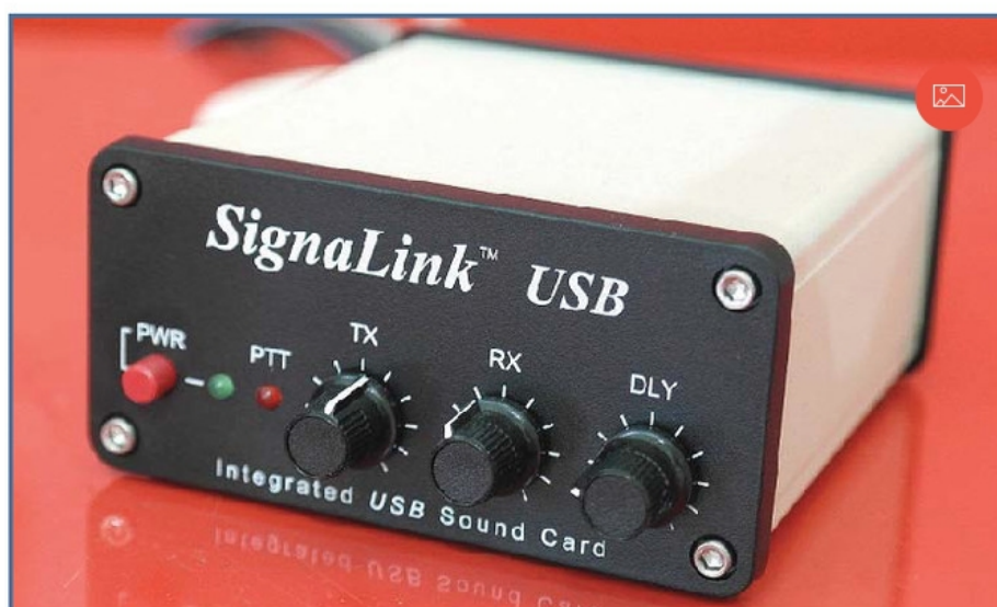
Fig. 1 - Per usare il modem “virtuale” Vara serve una radio Ssb con porta audio Usb; gli apparecchi che ne sono sprovvisti possono usare una scheda esterna.
