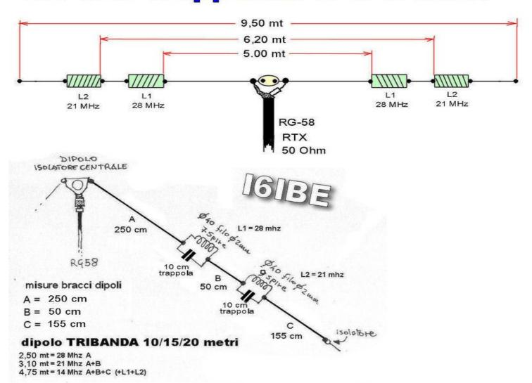
Lo schema del dipolo è quello classico trappolato full size, nel senso che le trappole hanno funzione di "interruttori" e non quello di CARICARE il radiatore per rendere la lunghezza totale inferiore al classico ¼ L.
