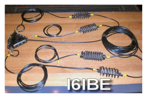
In questa invece l'intero dipolo assemblatoe pronto all'uso, il "centrale" è quello originale debitamente restaurato, il cavo di discesa è formato da circa 10 metri di cavo RG58
