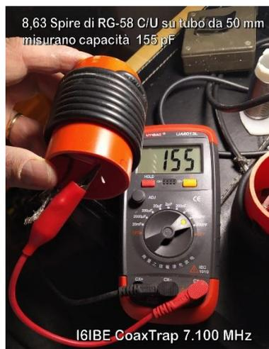
8,63 Spire di RG-58 C/U su tubo da 50 mm misurano capacità 155 pF
