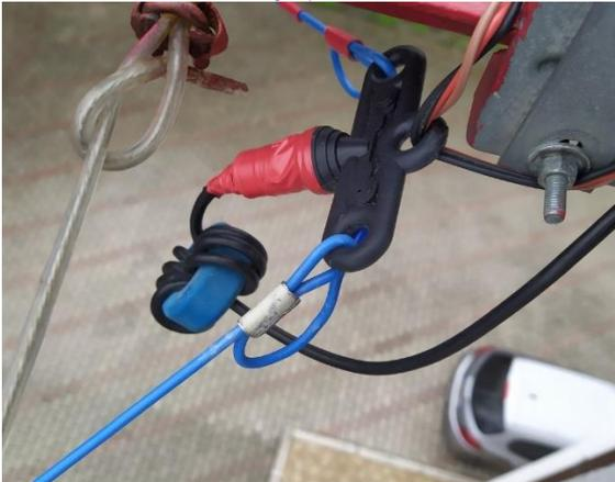
Particolare CENTRALE per DIPOLO e CHOKE RFI
