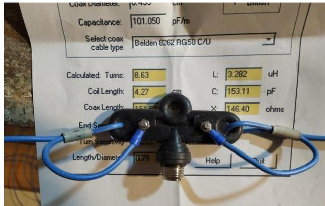
particolare fissaggio cavi sul CENTRALE DIPOLO
