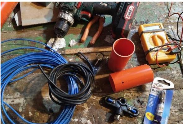
Materiale occorrente, filo elettrico rame da 2,5 mm, centrale dipolo, RG-58, supporto tubo 50 mm
