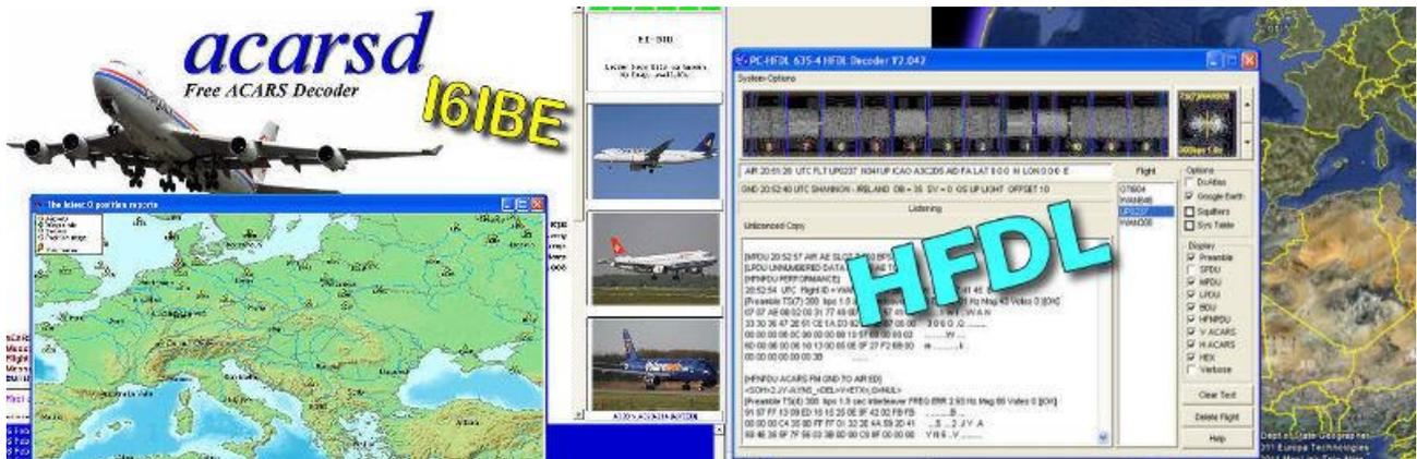
**ACARS (Aircraft Communication Addressing and Reporting System)** utilizza trasmissioni AFSK con toni 1200-2400 Hz mark e space, ogni pacchetto irradiato sulla frequenza VHF Europea AM (modulazione di ampiezza) operante su **131.725 Mhz**, contiene i seguenti dati, data, ore, Eventuale messaggio testuale, coordinate GPS per la localizzazione, piano di volo, numero del volo ecc.
