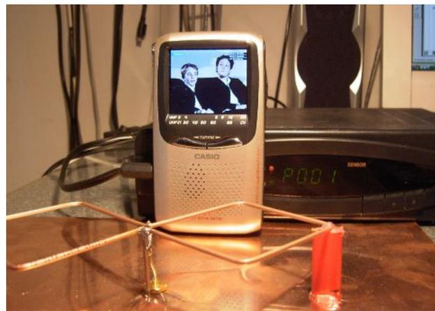
Io ho preferito montare il condensatore direttamente sull'antenna (vedi foto) soluzione senz'altro meno invalidante per il decoder, e di più facile realizzazione.
