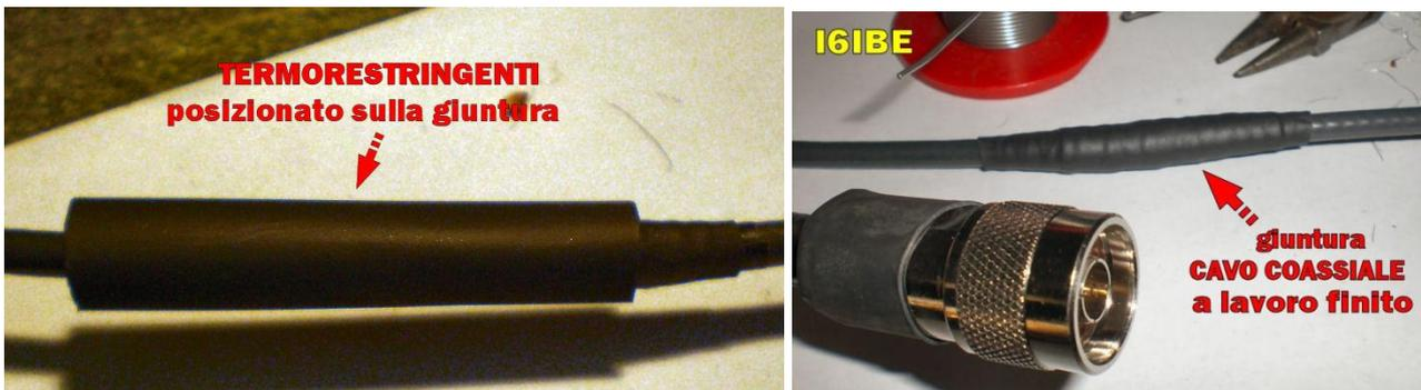
Ho utilizzato questo sistema di giuntura per la mia antenna BIBANDA posta nel QRL, alimentata da un RTX Yaesu FT-7800 per operazioni principalmente UHF, cavo esposto alle intemperie, e da oltre un anno non ho mai riscontrato il ben che minimo problema. Lo stesso dicasi per le antenne satellitari, stub, accoppiatori, partitori di impedenza saldati senza interposizione di bocchettoni.
