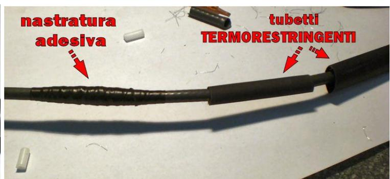
Fatto ! il cavo ora è come nuovo, perdite inesistenti, a costo zero. Il cavo coassiale utilizzato nelle foto e del tipo H-155 Belden, diametro 7 mm circa (leggermente più grosso di un RG-58), per cavi più spessi (RG-8 o RG-213) le operazioni di giuntura risulteranno decisamente più facili.
