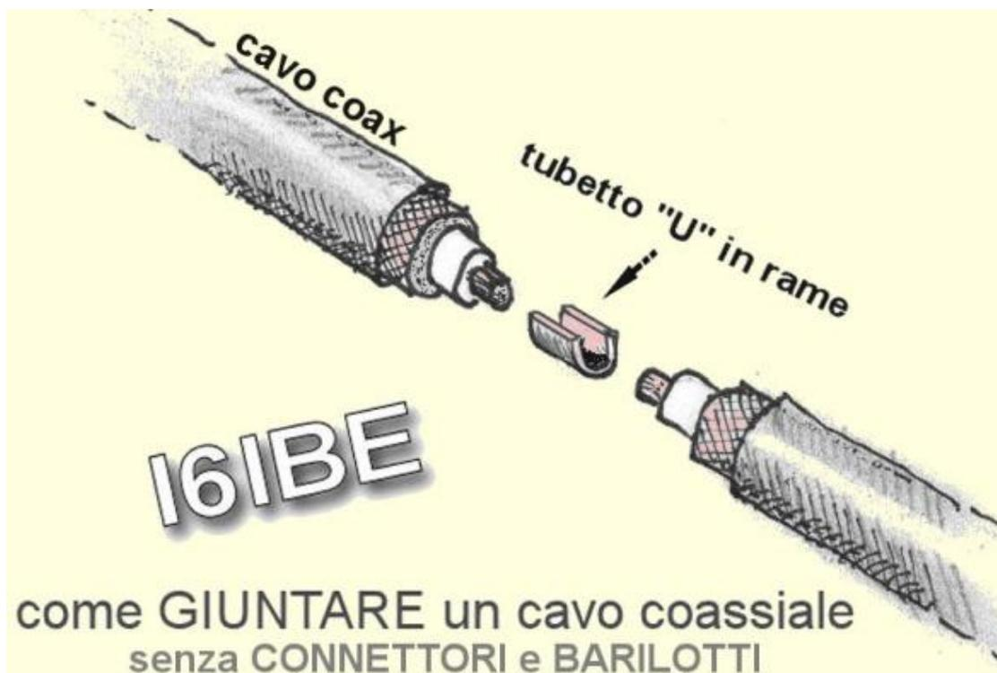
A peggiorare le cose la grandezza spropositata dei connettori e barilotto che ne impedirebbero il passaggio in una eventuale canaletta sotto traccia, la poca resistenza alle intemperie, infiltrazioni di acqua potrebbero ossidare e fare degenerare la giunzione. Ovviamente i bocchettoni hanno un costo e introdurranno perdite, idem il barilotto e se le saldature non sono ben fatte le perdite di inserzione aumenteranno in modo esponenziale, con questo sistema è facile perdere un paio di dB.
