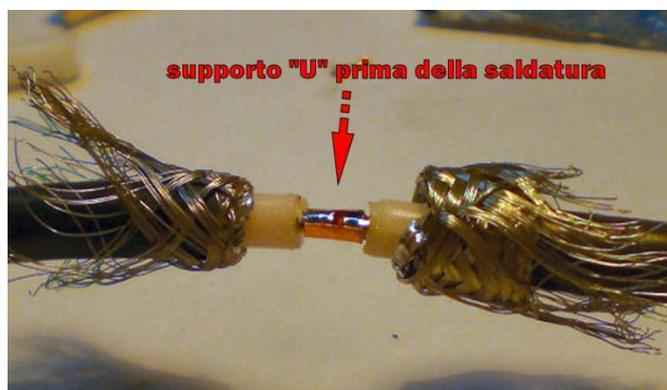
Dopo aver saldato il CENTRALE, riposizionare l'isolante in **TEFLON**, ricoprite il tutto con l'originale carta **STAGNOLA**, e sovrapponetevi le **CALZE** in rame per qualche centimetro evitando volutamente la saldatura, **NASTRATE** abbondantemente e strettamente la giuntura per evitare infiltrazioni di acqua, ricoprite la giuntura appena fatta, con due strati di diametri diversi, di tubetti **TERMO-RESTRINGENTI** e rifinite con un accendino fino alla perfetta adesione della guaina.
