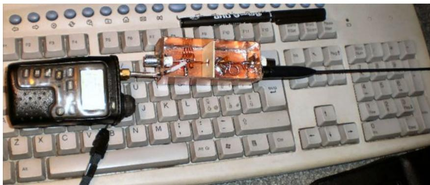
Se non disponete di adatta strumentazione oltre al solito tester e frequenzimetro ad occhio/orecchio saldate momentaneamente dei bocchettoni radio o spezzoni di cavo coassiale intestati in modo da poter collegare il FILTRO tra antenna e RTX...io per la taratura ho utilizzato uno Yaesu VX-3E, ho montato il filtro tra antenna portatile e lo Yaesu tramite connettori SMA.
