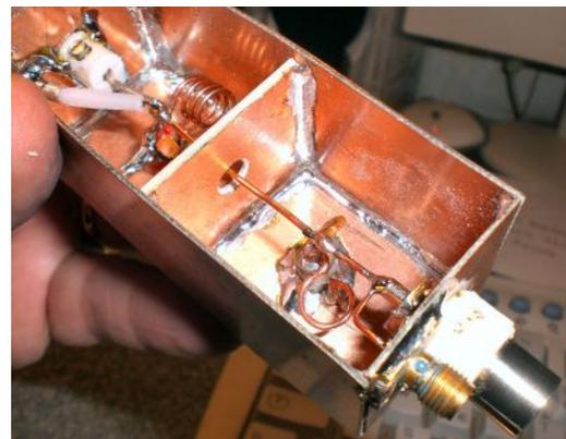
Ecco il lavoro terminato, un'oretta di puro divertimento. Per la taratura potrete rifarvi all'articolo originale di **IW0BYL Michele**, basta comunque sintonizzare, ruotando i relativi trimmer, il circuito per la gamma voluta, fino alla eliminazione totale del disturbo, tutto lì !
