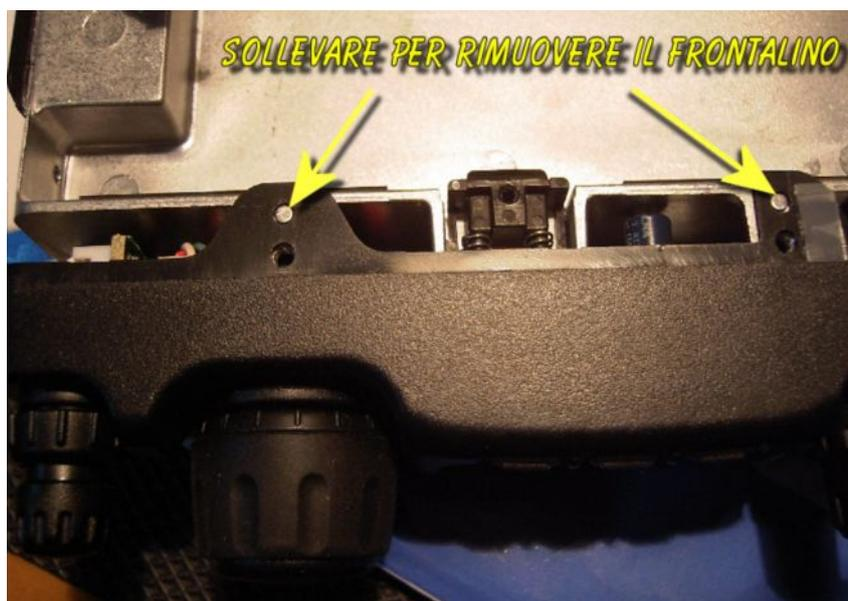
⌘ attenzione al FLAT-CABLE che lo collega al corpo dell'apparato, evitate di staccarlo.
