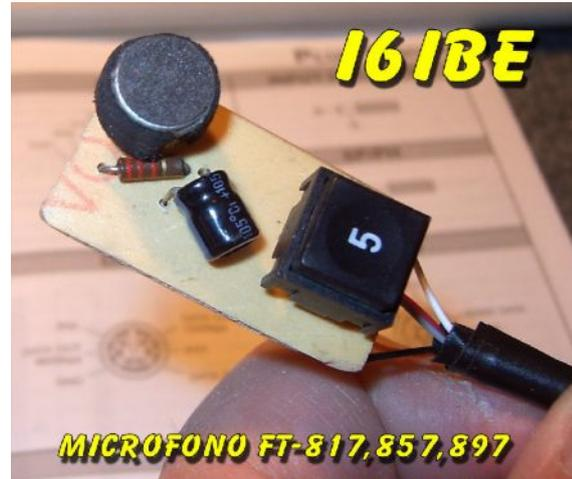
L'alimentazione di 5 volt necessaria per la capsula preamplificata a fet e' presente nel connettore microfonico, una basetta millefori si presta benissimo al montaggio, io ho realizzato, come al solito un piccolo circuito stampato "fresato" evitando master e immersione nel cloruro ferrico.
