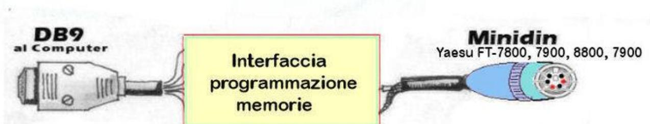
Questa interfaccia di programmazione memorie, rispetto a quella originale Yaesu, risulta molto più semplice da realizzare, si passa da 6 transistor a soli 2. Il costo di realizzazione
