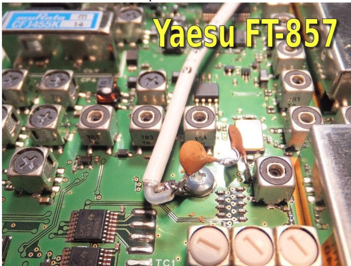
Ricordo che per questo tipo di modifiche sono assolutamente vietati saldatori a mannaia o acetilene ⚠, occorrono occhiali ingranditori e saldatore a stagno a punta fine da 6 watt che non disperda corrente di rete, quindi di buona qualità, tanta
