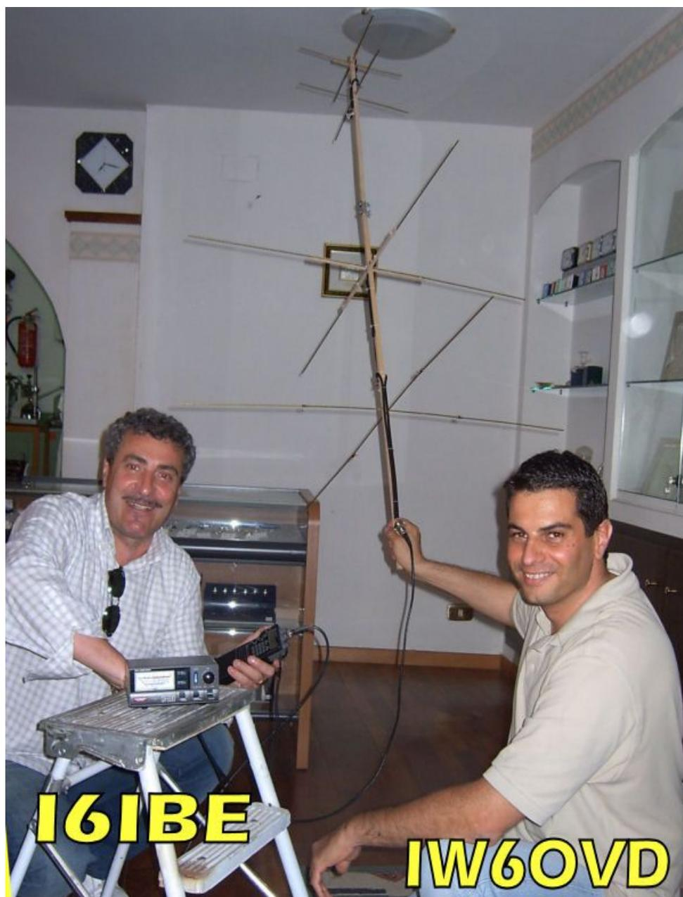
I6VMS consiglia di montare sullo stesso boom l'antenna per i 432 Mhz l'influenza reciproca sarebbe stata nulla ....diavolaccio di un Enzo, e' vero , le due antenne in asse non presentano variazioni significative di ROS, Il grosso vantaggio sta nel fatto che una volta puntato il satellite e inseguito manualmente saremo perfettamente allineati in ricezione e trasmissione. Ora tutto e' pronto per la prova finale.
