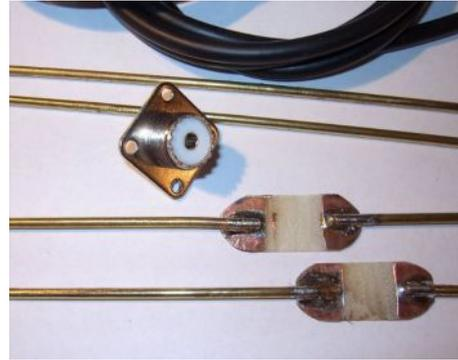
Gli altri due spezzoni di cavo servono per adattare l'impedenza tipica ai 52 Ohm nominali (trasformatore a  $\lambda/4$ ), Il R.O.S e' del tutto inesistente, 1,1:1 il che la rende praticamente perfetta anche in trasmissione, per eventuali Uplink 435 Mhz su VO-52.
