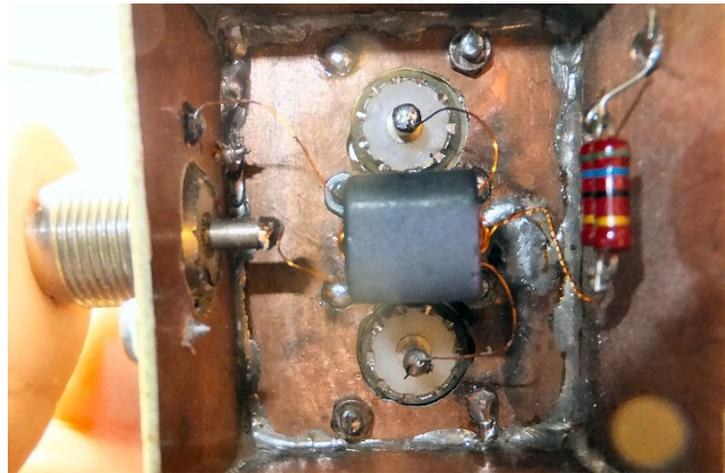
La costruzione con la ferrite binoculare e' semplice, si tratta di fare un avvolgimento primario di 12 spire con filo sottile in rame smaltato da 0,2 mm, mentre il secondario e' formato da 8+8 spire (16 spire con presa centrale) utilizzando lo stesso filo di rame smaltato. Un resistore da 27 Ohm bilancerà le uscite a 50 Ohm ( io ho utilizzato 2 resistenze da 56 Ohm in parallelo).
