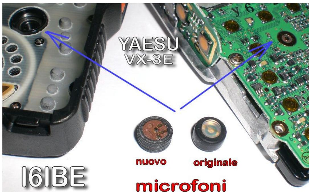
Stranamente sul nuovo VX-3 viene montata una capsula microfonica con caratteristiche simili a quella del VX-2 , ma con i contatti verso la piastra “main board” a striscia conduttiva. Soluzione a dir poco sconcertante, l'esiguo spessore di questa striscia non permette margini, non creando assolutamente un “contatto” stabile, elettricamente certo e duraturo con i contatti dorati della circuiteria frontale del rtx.
