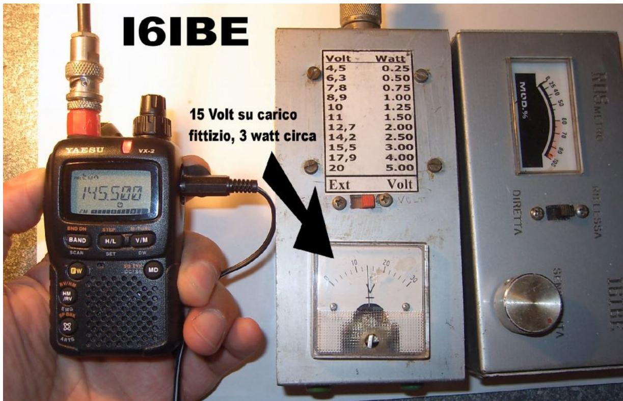
Anche il VX-2 come tutte le apparecchiature Icom e Yaesu permette la programmazione da computer attraverso il jack microfonico a 4 poli sul contatto "dati", l'interfaccia e' la solita, il programma e' reperibile in rete gratuitamente, in questo caso scaricate VX-2 COMMANDER
