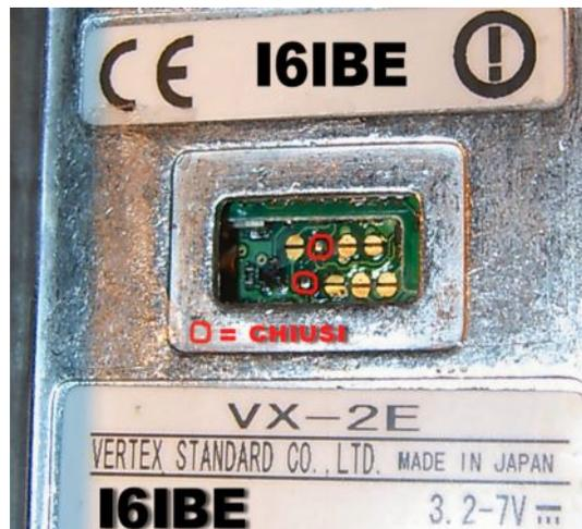
La modifica hardware va eseguita sotto il vano batteria con un saldatore a punta fine e a basso wattaggio, vanno dissaldate o cortocircuitate le piazzole in rame a seconda di quello che si vuole ottenere, il lavoro va eseguito da mani esperte, una goccia di stagno lasciata cadere inavvertitamente dentro al vostro rtx potrebbe comprometterne definitivamente la funzionalità.
