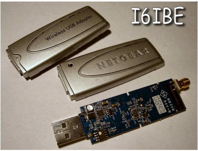
Le saldature da individuare e da fare son solo due , l'uscita RF ed il contatto di massa. Il primo fa capo all'antenna interna , all'inizio della striscia dorata , il secondo, la massa puo' essere
