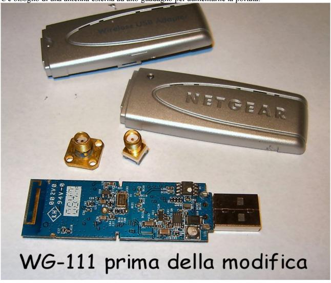
Apro delicatamente la chiavetta, ( i gusci sono tenuti insieme a pressione tramite due linguette al centro, sotto le etichette adesive con impressi il MAC e MODELLO) occhio allo smontaggio, il
