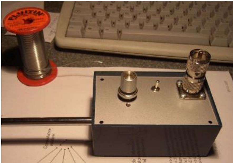
Date un'occhiata allo schema elettrico e di montaggio per meglio capire come sistemare le varie cose. Ecco la vostra antenna terminata pronta a funzionare, lavoro niente male, un connettore doppio maschio BNC permette di montare l'antenna direttamente dietro al FT-817, io ho preferito utilizzare un corto spezzone di cavo coassiale RG-58 per collegarla all'RTX.
