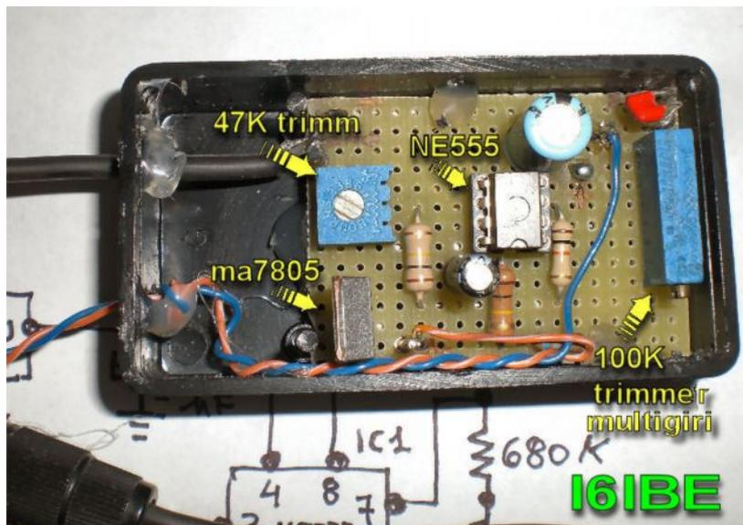
Lo schema originale e' di **MAK SV1BSX** Radioamatore Greco, genera un tono audio di **88,5 Hz** , richiede una tensione di alimentazione di 5 volt, io ho aggiunto uno stabilizzatore **ma7805** e qualche condensatore per avere un ampio range di alimentazione che passa a 9-15 Volt, tensione sicuramente più reperibile all'interno della stazione radio e su vecchi apparati radio.
