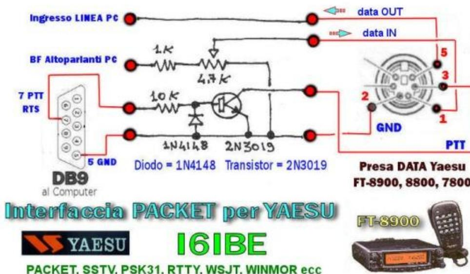
Se il vostro PC non dispone di porte COM risulta possibile l'utilizzo anche di porta PARALLELA per stampanti o dei nuovi convertitori USB-RS232 da USB a COM.
