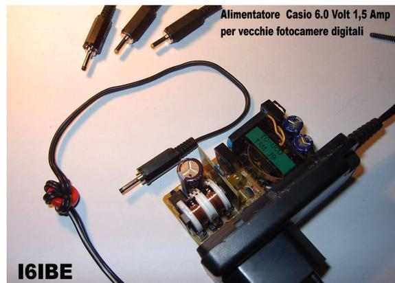
Le successive prove confermano la bontà e qualità dell'alimentatore che permette di far erogare al TX ben 3 watt permettendo qso altrimenti impossibili in bassa potenza e comunque permette di economizzare le batterie quando si opera in casa con antenna esterna.
