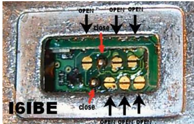
Tale modifica e' bene lasciarla come risoluzione ultima, le foto mostrano la configurazione hardware del mio apparato e comunque anche smontando completamente il VX-2 non e' possibile accedere al lato saldature (ponticelli) che si trova proprio sotto la scocca pressofusa quindi occhio se operate in questo modo, il rischio di ritrovarvi un rottame tra le mani e' reale.
