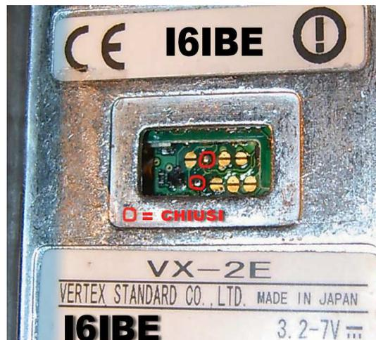
La modifica hardware va eseguita sotto il vano batteria con un saldatore a punta fine e a basso wattaggio, vanno dissaldate o cortocircuitate le piazzole in rame a secondo di quello che si vuole ottenere, il lavoro va eseguito da mani esperte, una goccia di stagno lasciata cadere inavvertitamente dentro al vostro rtx potrebbe comprometterne definitivamente la funzionalita'.
